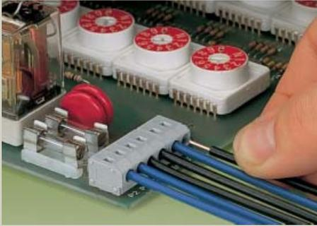
Подключение проводников без использования нажимной кнопки
