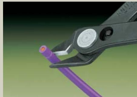
Если необходимо повторно подключить проводник, необходимо ровно отрезать использованную часть. Для повторного подключения можно использовать только проводник того же типа и сечения
