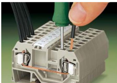
Подсоединение проводников фронтальное подключение серии от 279 до 285
