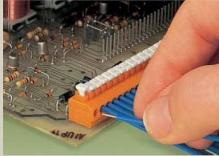
Подключение проводников с использованием нажимной кнопки
