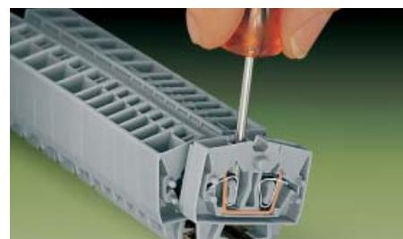
... и затем снять с рейки.
