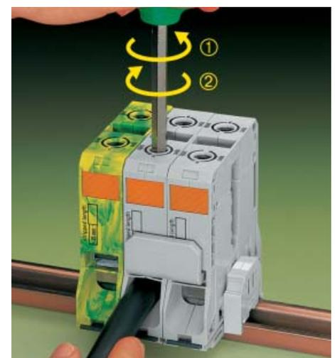
... коротким поворотом ключа влево расфиксировать стопор ①. Повернуть ключ вправо и вынуть его из клеммы ② Проводник надежно зажат в клемме.
