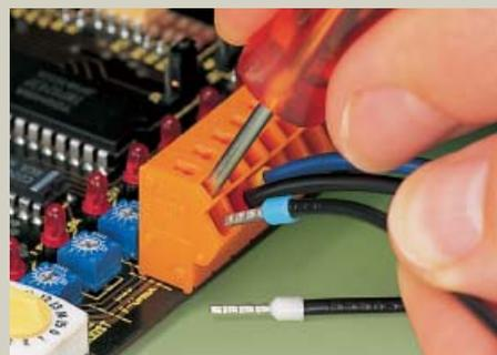
Подключение проводников - многожильный с обжимной трубчатой втулкой
