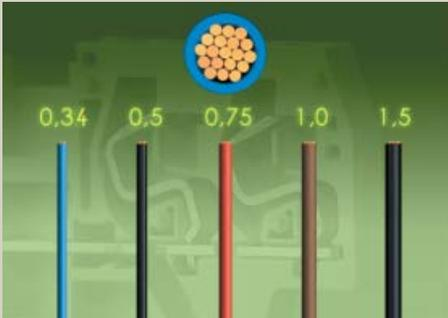
Возможно использование многожильных проводников от 0.34 мм² / AWG 22 до 1.5 мм² / AWG 16
