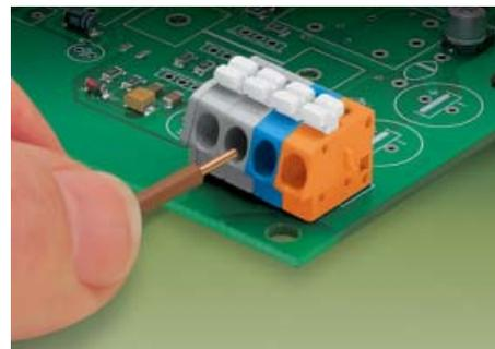
Подключение одножильного проводника:
